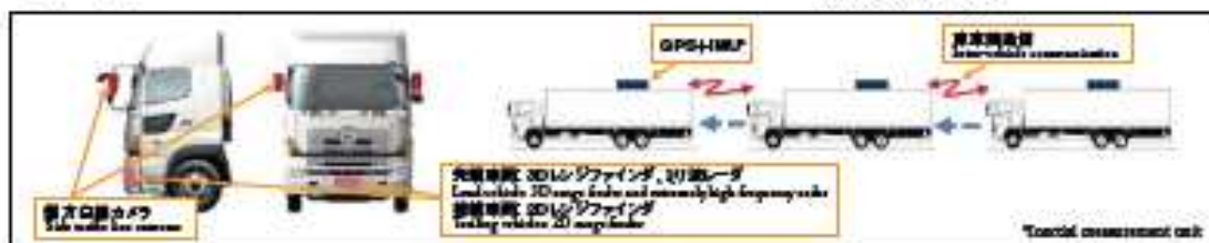
隊列走行システム構成 Elements of platooning system
